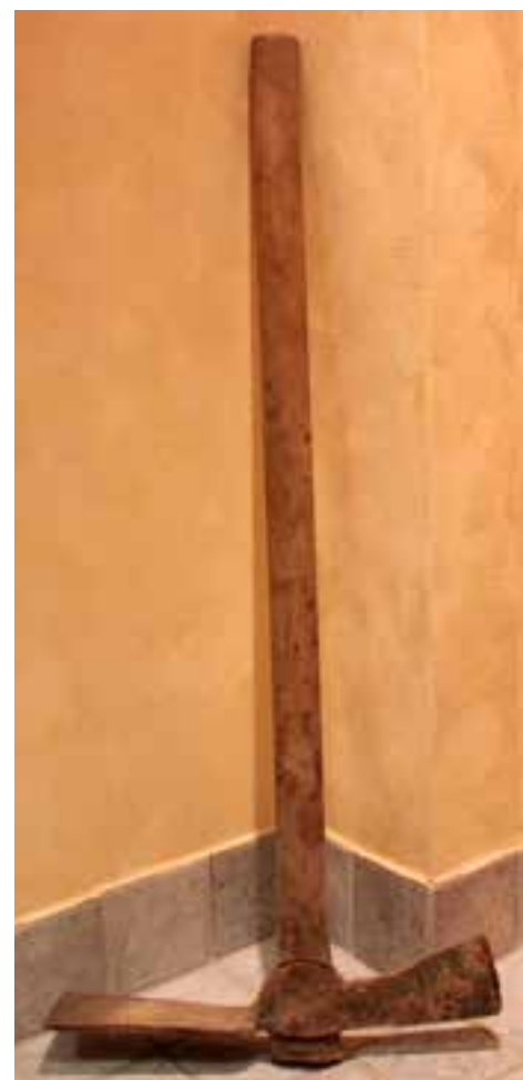
Brandyxa som användes av Frinnaryds brandkår för att riva väggar och dörrar.
