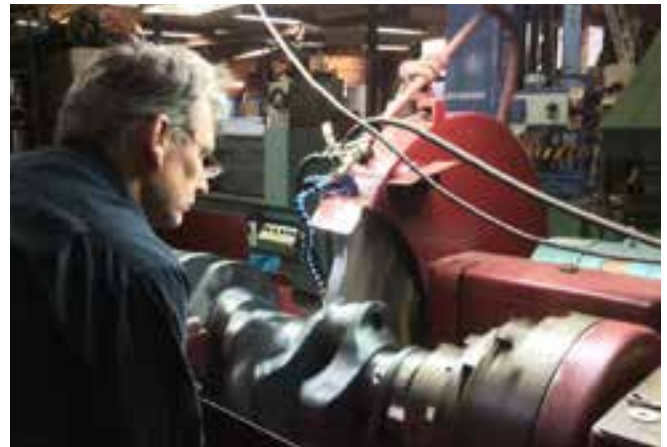
Noggrannhet är A och O när man renoverar motorerna. Inget får lämnas åt slumpen - här är det Calle som slipar en vevaxel till en catmotor.
